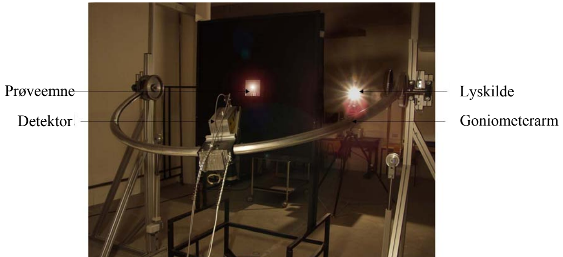
Figur 8. Goniospektrofotometret ved måling transmittans. Lyskilden er placeret vinkelret på prøveemnet i en afstand på 3m.
