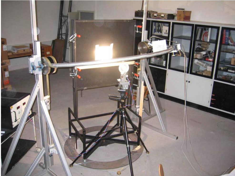
Figur 9. Goniospektrofotometret ved måling af reflektans. Lyskilden er placeret på samme side som prøveemnet. Som reference anvendes et spejl med kendt spektralfordeling af reflektansen.
